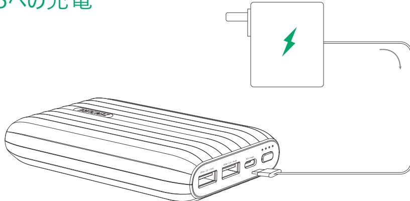
USB-C充電ケーブルで電源のACアダプタからX5のUSB-Cポートに接続します。
